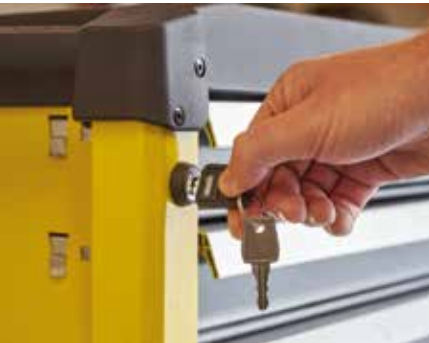
CERRADURA FRONTAL CON UNA LLAVE ARTICULADA PARA EVITAR ROMPERLA AL MANIPULAR LOS CAJONES.
